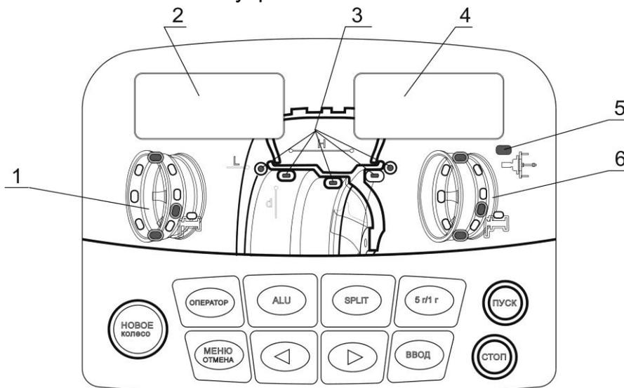
1, 6 – индикаторы положения груза; 2, 4 – цифровые индикаторы, 3 – индикатор схемы расположения грузов, 5 – индикатор режима компенсации адаптера
