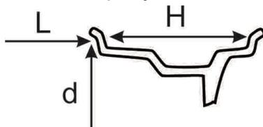
Рисунок 5.4 – Размеры диска при традиционном вводе
