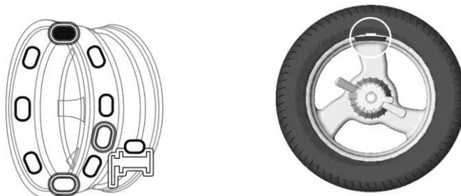
Рисунок 6.3 – Груз установлен в положение «12 часов»
