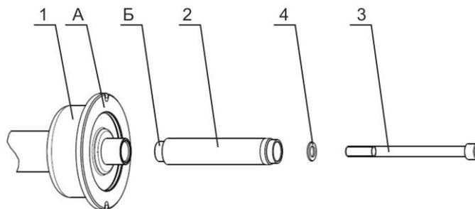
Рисунок 4.2 – Сборка вала
