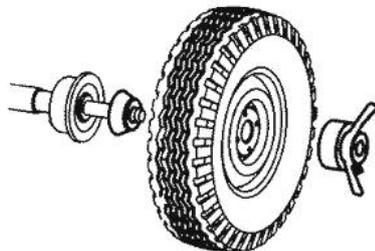
Рисунок 6.5 – Установка колеса
