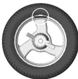
Рисунок 6.5 – Груз установлен в «12 часов»
