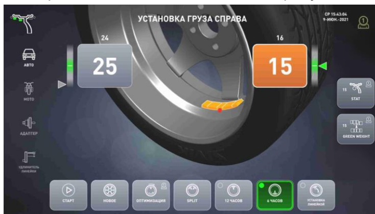
Рисунок 5.8 – Установка в «6 часов» справа
