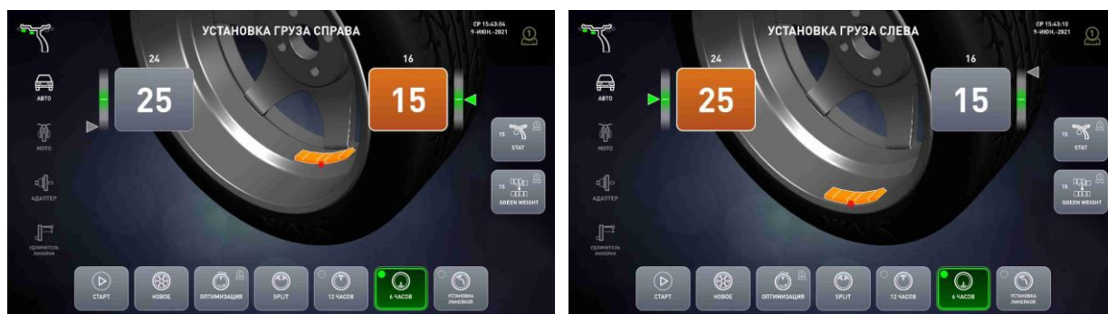
Рисунок 6.10 – Схемы установки грузов
