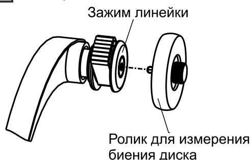
Рисунок 8.7 – Ролик для измерения биений
