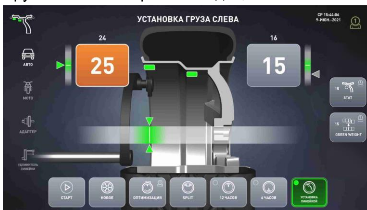
Рисунок 5.10 – Экран при установке груза линейкой
